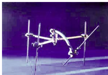
Fig. 2 Il compasso di Hirtz (Per gentile concessione del Museo Belga di Radiologia)
