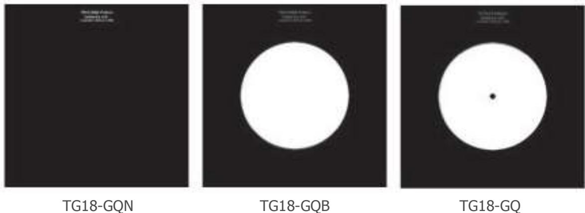
Figura 6.2 Immagini di test per la valutazione quantitativa del *veiling glare*
