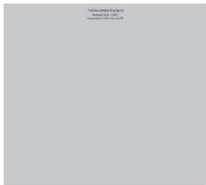
Figura 5.16 Immagine di test TG18-UN80 per la valutazione qualitativa dell'uniformità della luminanza, dell'uniformità della cromaticità e del flicker
