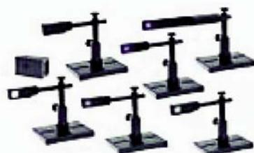
Sfruttano l'effetto fotoelettrico prodotto dai fotoni incidenti, che devono avere energia superiore al salto energetico esistente tra banda di conduzione e banda di valenza per poter produrre coppie elettrone-lacuna.
