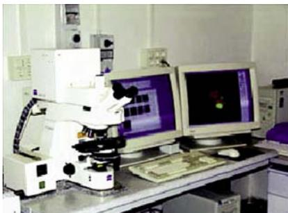
❖ Microscopio Confocale a scansione laser: la microscopia confocale fornisce uno strumento per poter visualizzare simultaneamente tramite segnali in fluorescenza proteine, organelli cellulari e DNA attraverso singole sezioni “tagliate otticamente” all'interno. Anche questi strumenti, pur contenendo laser di classe 3B o 4, sono generalmente classificati come prodotti di classe 1.
