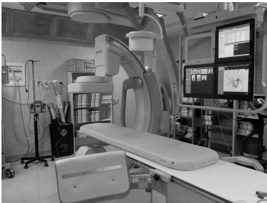
Figura 3.1a. Apparecchio monoplano con flat panel (su gentile concessione Fondazione IRCCS Policlinico S.Matteo Pavia)
